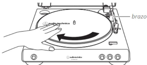
8. Retire la atadura de plástico que asegura el brazo a su reposo y deséchela.
